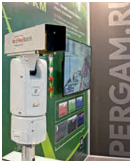
КОМПЛЕКС IQ FIREWATCH СПОСОБЕН ВЫЯВИТЬ ОЧАГИ ЛЕСНЫХ ПОЖАРОВ НА МНОГО КИЛОМЕТРОВ ВОКРУГ
